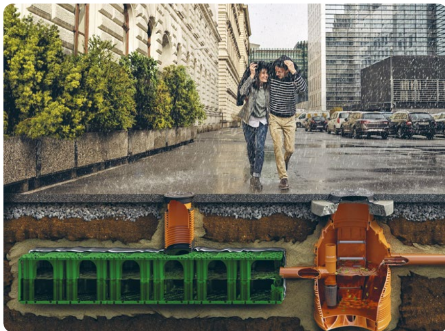
Foto 18. Vett mitteläbilaskva katendi all asuva imbkaevu läbilõige. Allikas: www.pipelife.com
