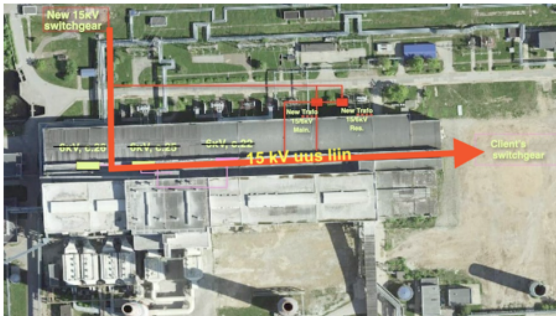
Skeem 4. Elektrivarustuse tagamine väljapoolt planeeringuala planeeringualani, (Enefit Power AS esialgne skeem, täpne lahendus selgub planeeringu koostamise käigus).
