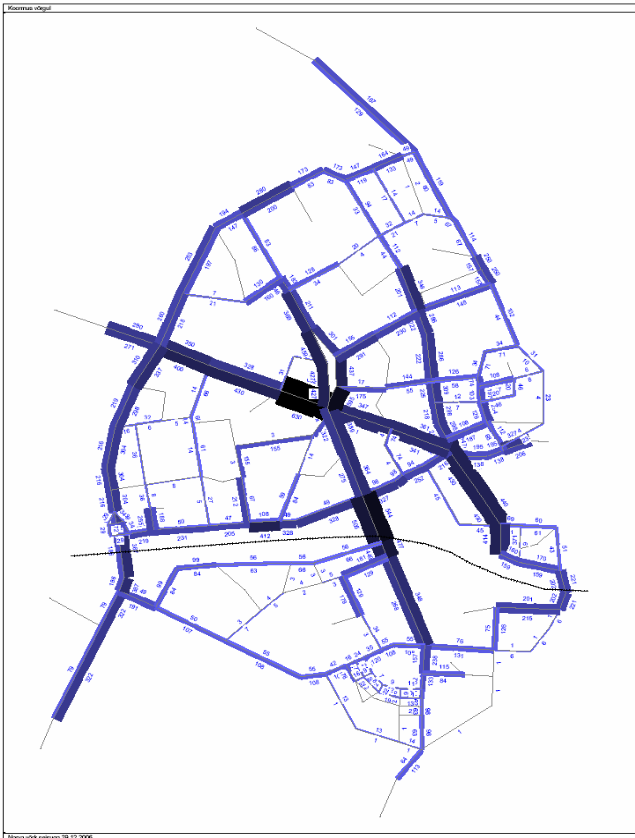
Joonis 13. Liikluse mudel 2006 õhtune tipptund (Narva linna transpordi arengukava 2009-2015, 2008).
